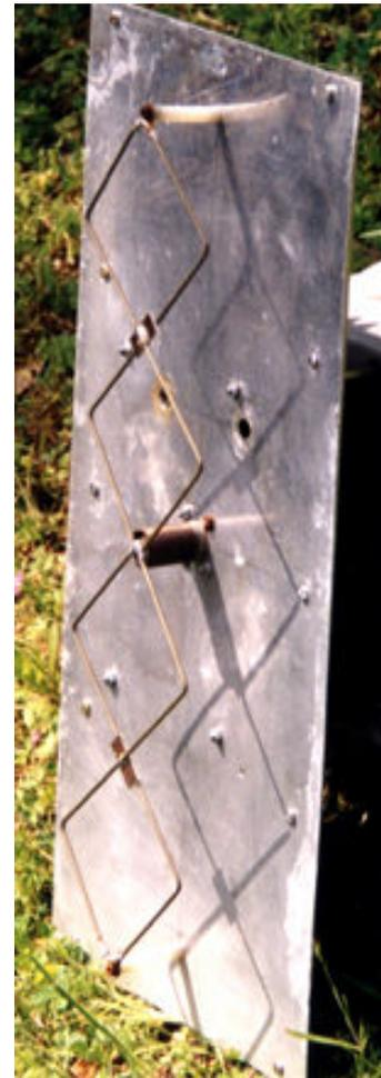
L'antenne est à placer à 26-30 mm du plan réflecteur, cette distance peut être ajustée pour un ROS ou un gain ou un lobe de rayonnement optimum. De petits morceaux de circuit imprimé double face servent d'isolants entre les fils de cuivre.
